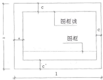
图12.2.2 规格幅面图纸的尺寸示意
